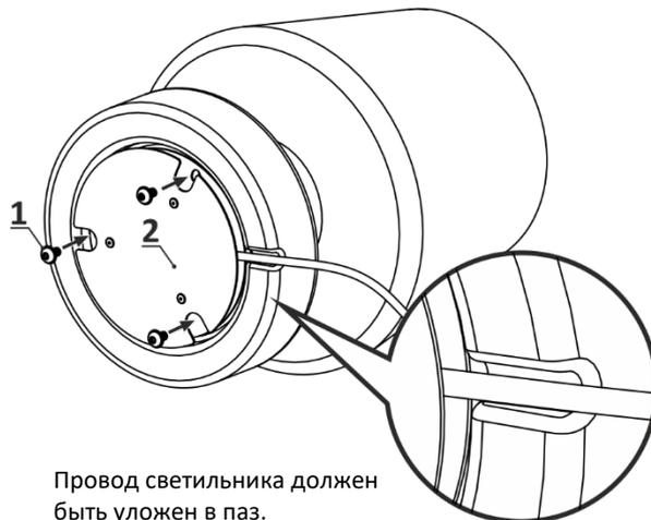
Провод светильника должен быть уложен в паз.
