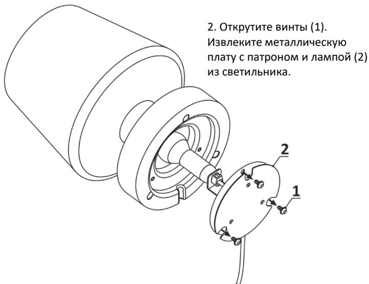
2. Открутите винты (1). Извлеките металлическую плату с патроном и лампой (2) из светильника.
