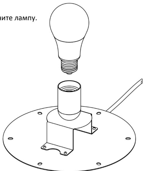
4. Установите металлическую плату (2) на место. Зафиксируйте её с помощью винтов (1).
