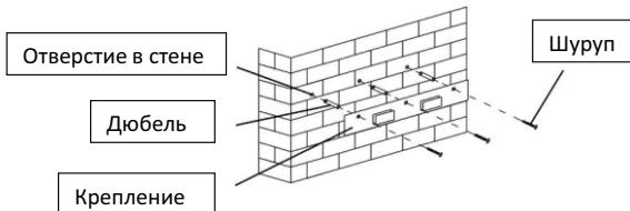
2. Просверлите еще 4 отверстия, используя сверло на 8 мм, чтобы зафиксировать вытяжку на стене позже.
