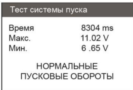
Данный тест позволяет техническому персоналу по времени пуска и минимальному напряжению быстро определить состояние системы запуска двигателя. Если напряжение при запуске ниже 9.6В, то это означает, что АКБ неисправна. Если напряжение выше 9.6В, то АКБ в порядке.
