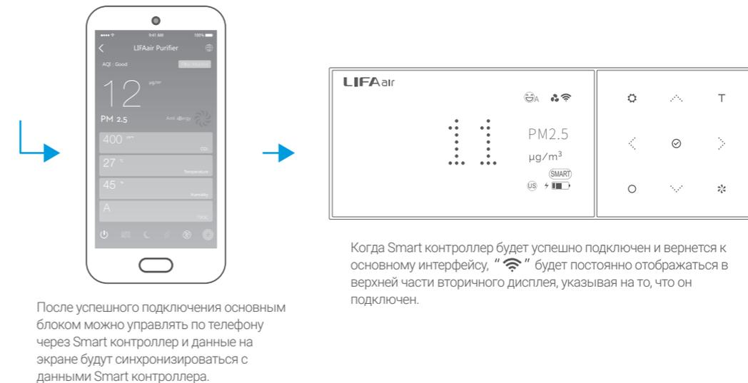
Примечание: Для управления основным блоком с телефона и считывания данных, таких как температура, влажность, срок службы фильтра и т.д., Smart контроллер должен быть подключен к основному блоку.
