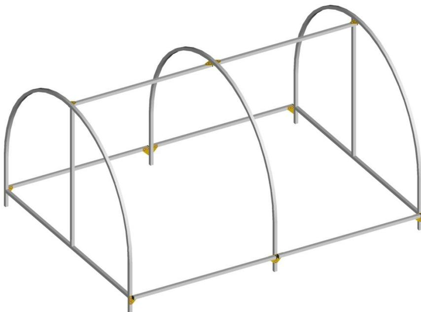
**Рис. 2.3.** Сборка каркаса для мини-парника размером 2х1,5 м (базовый комплект)
