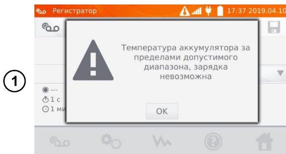
При достижении температуры критических значений, измеритель блокирует процесс зарядки.
