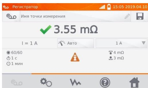
Дисплей отобразит результат измерения и количество записанных точек измерения.
