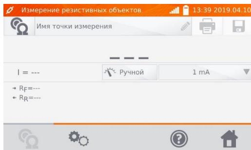
Переключение типа регулирования измерительного тока **Авто/Ручной**
