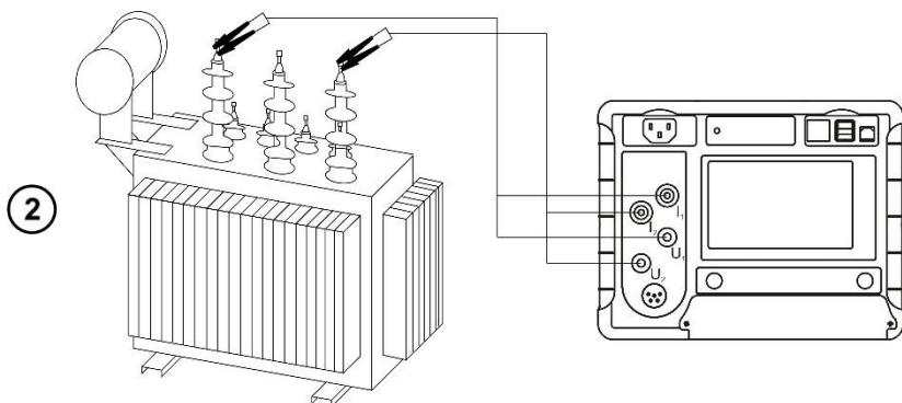
Подключите измеритель к обмотке трансформатора.
