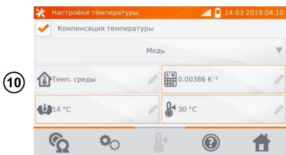
При включении температурной компенсации необходимо ввести все значения (поля, отмеченные красной рамкой обязательны для заполнения), для перехода к экрану измерения.
