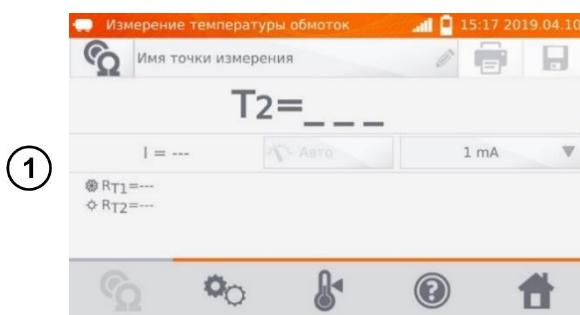
На экране **Специальные функции** нажмите **Измерение температуры обмоток**.
