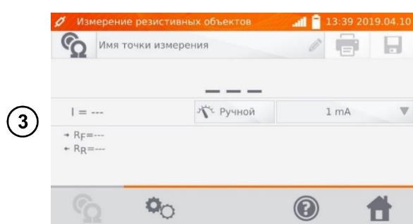
Переключение типа регулирования измерительного тока Авто/Ручной
