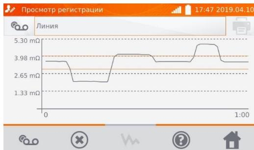
В случае **Регистрации**, нажатие поля с результатом вызовет отображение отдельных измерений с возможностью их прокрутки с помощью кнопок
