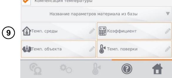
После отметки поля **Компенсация температуры**, измеритель рассчитывает на основе введённых температур и температурного коэффициента сопротивления, значение сопротивления для заданной температуры.
