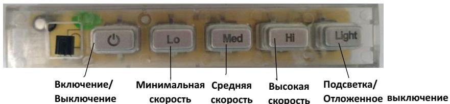
**Описание:** после подключения вытяжки к сети все индикаторные лампы загорятся синим светом и погаснут со звуковым сигналом. Нажатие кнопок всегда сопровождается звуковыми сигналами. Световой индикатор продолжит мигать во время работы устройства.
