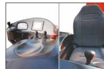
Двойной многопозиционный джойстик и комфортное подвесное сиденье оператора
