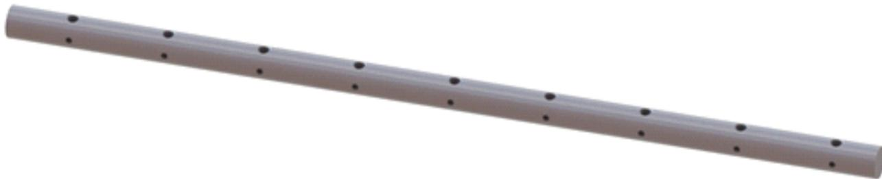
**Является основным узлом станка, имеет отверстия для установки державки твердосплавных пластин, а также винты фиксирующие державку в необходимом положении. Во время работы борштанга вращается дрелью и перемещается продольно при помощи каретки продольной подачи.**
