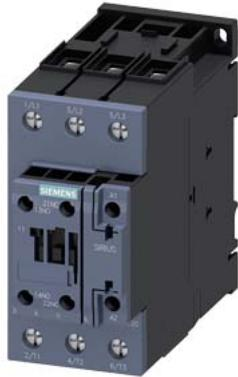
Силовой контактор, AC-3 40 A, 18,5 кВт/400 В 1 НО + 1 НЗ, 230 В AC 50 Гц, 3-полюсн., типоразмер S2, винтовой зажим
