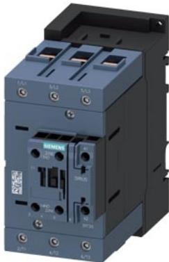
Силовой контактор, AC-3 80 A, 37 кВт/400 В 1 НО + 1 НЗ, 24 В DC 3-полюс., 3 НО, типоразмер S3 винтовой зажим Встроенный варистор подходит для выходов ПЛК 2 А
