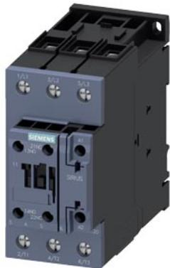
Силовой контактор, AC-3 40 A, 18,5 кВт/400 В 1 НО + 1 НЗ, 24 В DC с варистором, 3-полюсн., типоразмер S2, винтовой зажим подходит для выходов ПЛК 2 А
