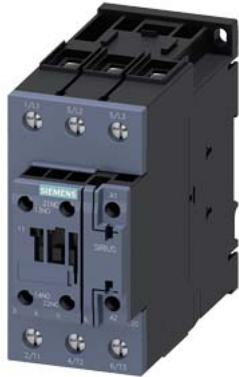
Силовой контактор, AC-3 80 A, 37 кВт/400 В 1 НО + 1 НЗ, 24 В AC, 50 Гц 3-полюс., типоразмер S2 винтовой зажим
