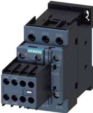
Силовой контактор, AC-3 25 A, 11 кВт/400 В 2 НО + 2 НЗ, 230 В AC, 50 Гц, 3-полюсн., типоразмер S0 винтовой зажим Выключатель вспомогательных цепей, разъемный
