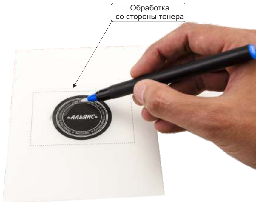
Рис.7 Обработка плёнки специальным карандашом для увеличителем плотности тонера.
