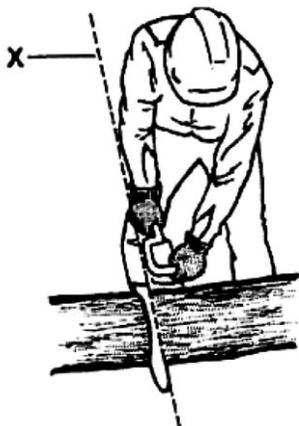
При распиловке ствола дерева займите положение тела, при котором Ваша правая рука должна быть расположена прямо по воображаемой линии X, являющейся продолжением линии пильной шины, а все тело должно находится слева от линии X (см. рис.11) При работе в целях безопасности, нельзя располагать какие-либо части тела за пределы воображаемой линии X.
