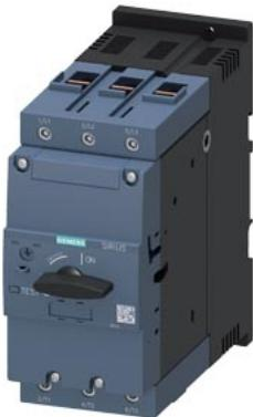
Автоматический выключатель, типоразмер S3 для защиты двигателя, класс срабатывания 10 Максимальный расцепитель тока с обратнозависимой выдержкой времени 75–93 A N-расцепитель 1300 A Винтовой зажим Стандартная коммутационная способность
