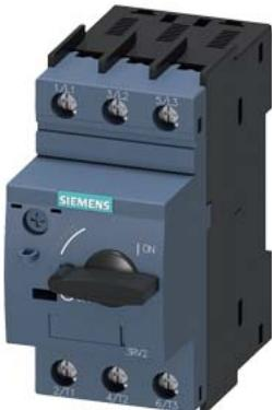
Автоматический выключатель, типоразмер S00 для защиты двигателя, класс срабатывания 10 Максимальный расцепитель тока с обратнозависимой выдержкой времени 1,1–1,6 A N-расцепитель 21 A Винтовой зажим Стандартная коммутационная способность
