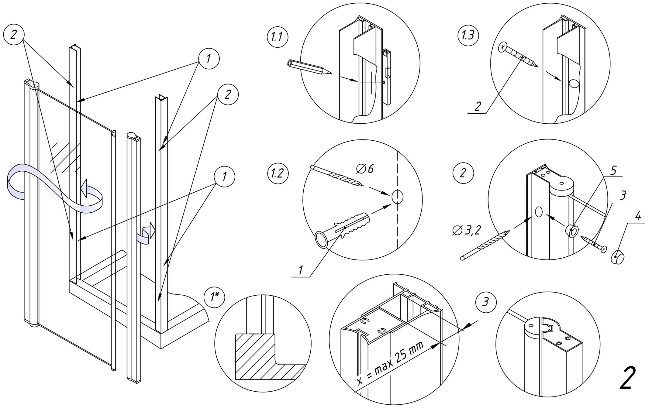
4. Произвести монтаж комплекта ручек. Для моделей EP и EP кноб ручки различны.
