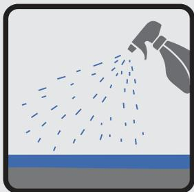
На обрабатываемое изделие наносится антипригарная жидкость **СВАРТЕК** в околошовную зону шириной до 100 мм.
