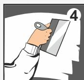
Нанесите шпатлевку в 1-2 слоя шпателем или кельмой. Второй слой нанесите не раньше, чем через 2 часа при толщине слоя до 2 мм, при более толстом слое время высыхания увеличивается. Шлифование финишного слоя производите через 2-4 часа после нанесения. Грунтование, окрашивание или другие отдельные операции производите не раньше, чем через 24 часа после нанесения последнего слоя. По окончании работы инструменты промойте водой.
