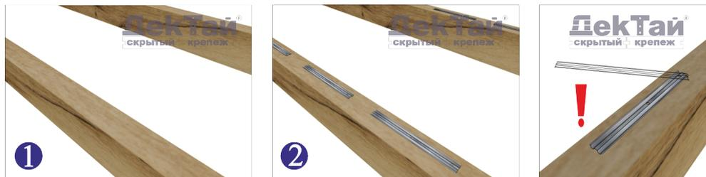
1. Подготовка к монтажу. Производим разметку лаг с определением мест, куда будет монтироваться крепёж.
