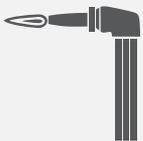
Благодаря образованию горючей смеси газов в мундштуке, а не в инжекторной камере, практически **исключается прохождение обратного удара** дальше мундштука, резак при этом остается полностью работоспособным.
