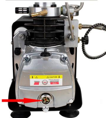
2. Перед началом работы извлеките крышку и установите сапун, который идет в комплекте с компрессором.
