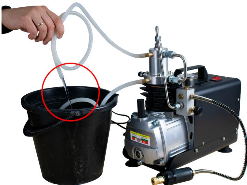
7. Подключите шнур питания и включите компрессор на несколько секунд. Из штуцера должен пойти напор воздуха. Выключите компрессор.
