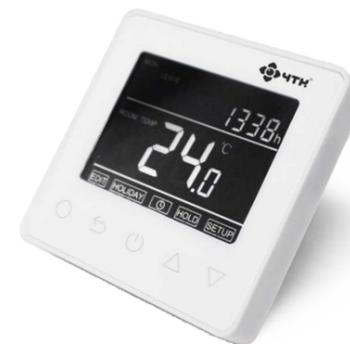
Программируемый электронный цифровой терморегулятор с сенсорным дисплеем, предназначен для регулирования и поддержания температуры в помещениях.
