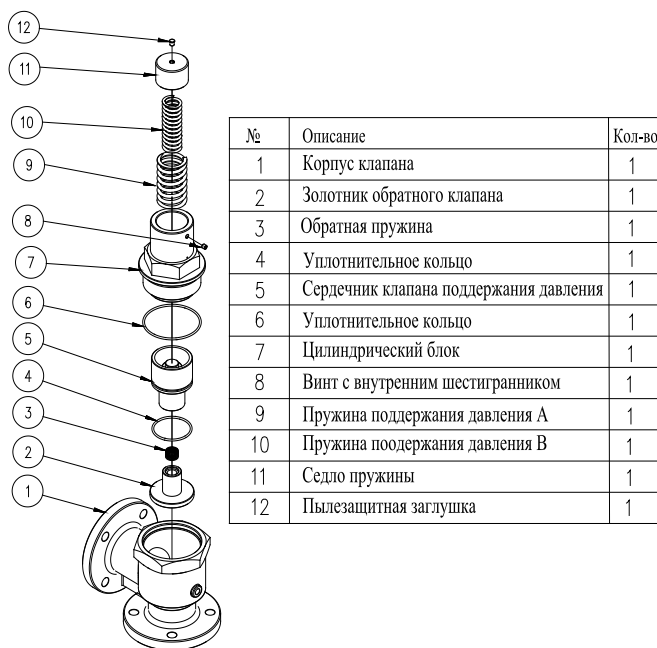
Рисунок 6-2 Клапан минимального давления
