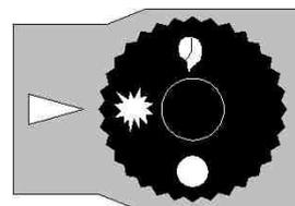
«Включено» – котел полностью включен, работают все горелки.
