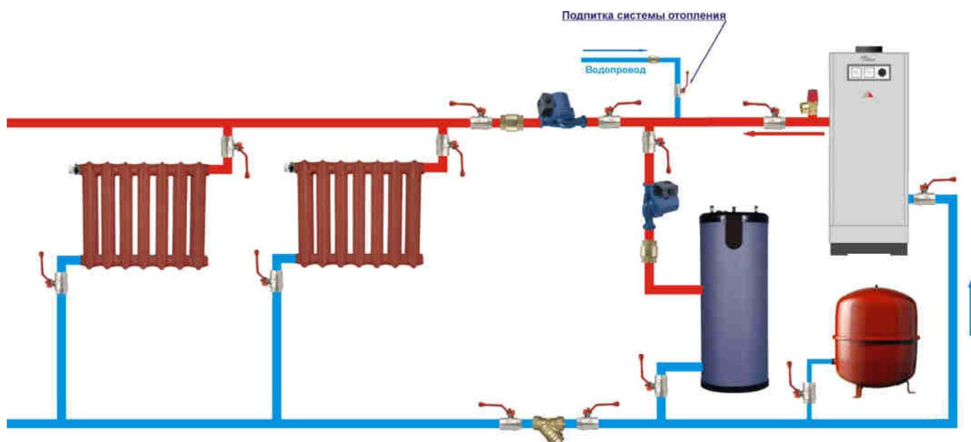
Рисунок 5. Схема подключения котла с принудительной циркуляцией теплоносителя
