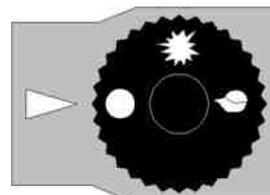
«Розжиг» – это положение используется для запуска котла. Чтобы подать газ к пилотной горелке для ее розжига необходимо установить регулятор в это положение и нажать на него до упора.
