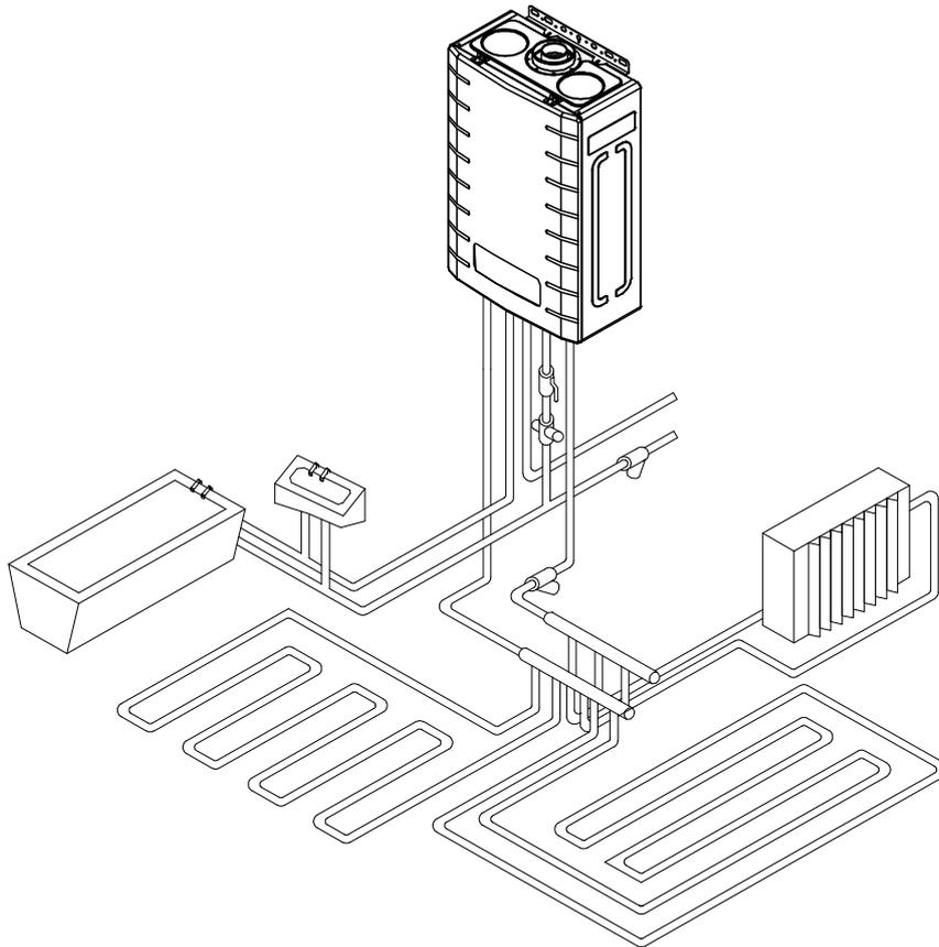
Рисунок 12. Пример монтажа системы отопления и ГВС.
