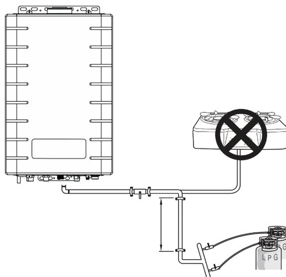
Рекомендуется установить два и более баллонов со сжиженным газом (G31, LPG), подсоединенных параллельно только для подачи газа в котел. Запрещается подключать к ним газовую плиту и другие приборы.
