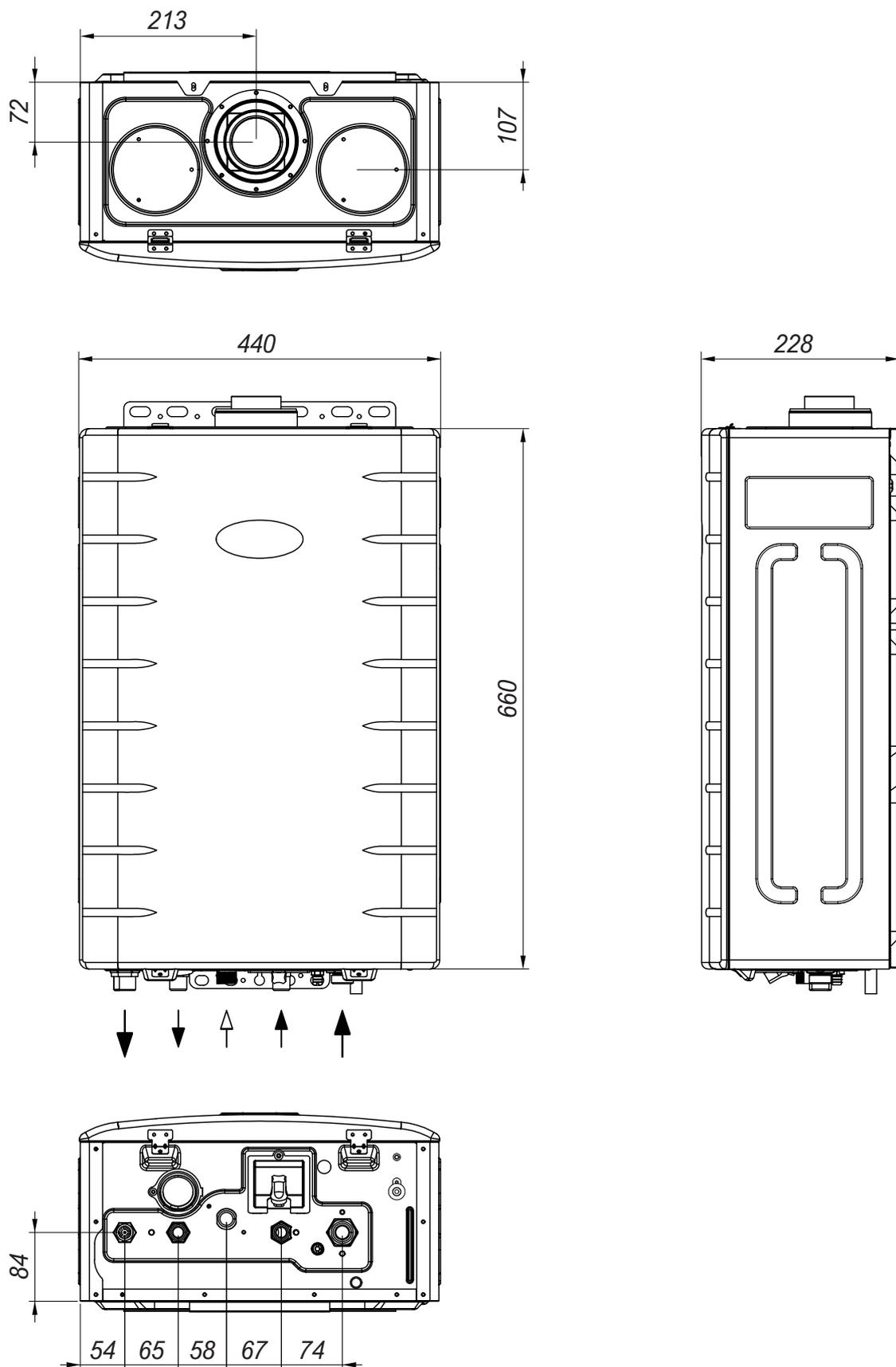
Рисунок 1. Габаритные размеры.
