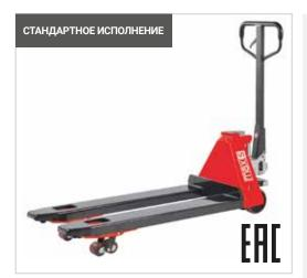
HPS2.0 Модель Q, KГ 2000 Грузоподъемность h13 (мм) 75/85 Высота вил в опущ. полож. 165/175 Высота подъема вил h3 (мм) Длина вил I (MM) 1150 b5 (мм) 540/570/705 Общая ширина вил Ø160 Рулевое колесо MM Подвилочное колесо ММ Ø70 Тип АКБ Сухая Мин измеряемый вес Κг 0,5 Погрешность измерения веса ±0.05 Радиус разворота W (MM) 1368 118/130 Общая масса
