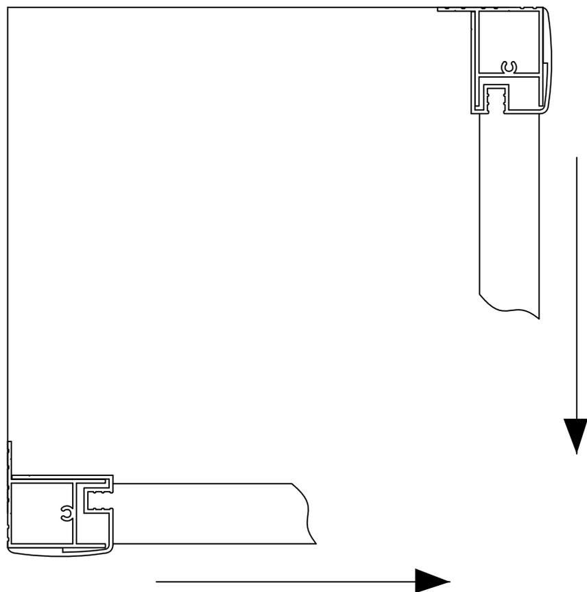
Регулировка осуществляется путем выдвигания профиля (максимально возможное выдвигание – 25 мм с каждой стороны).
