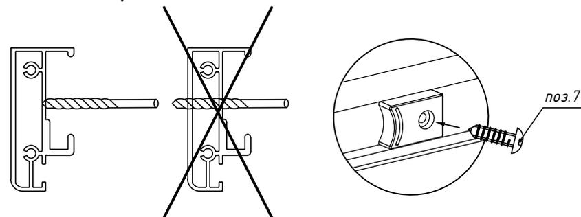
8. Произвести монтаж комплекта ручек. Ручка с монтажным отверстием устанавливается с внутренней стороны изделия. После установки ручек установить заглушки закрывающие винты.
