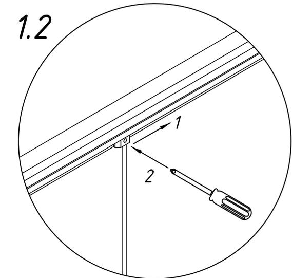
2. Равномерно по высоте распределить и просверлить отверстия в пристенных профилях (по 3 отверстия на каждый профиль).
