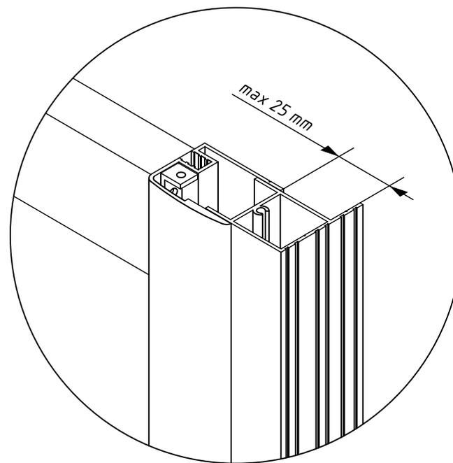
5. После регулировки ограждения, необходимо зафиксировать его в установленном положении, используя саморезы.
