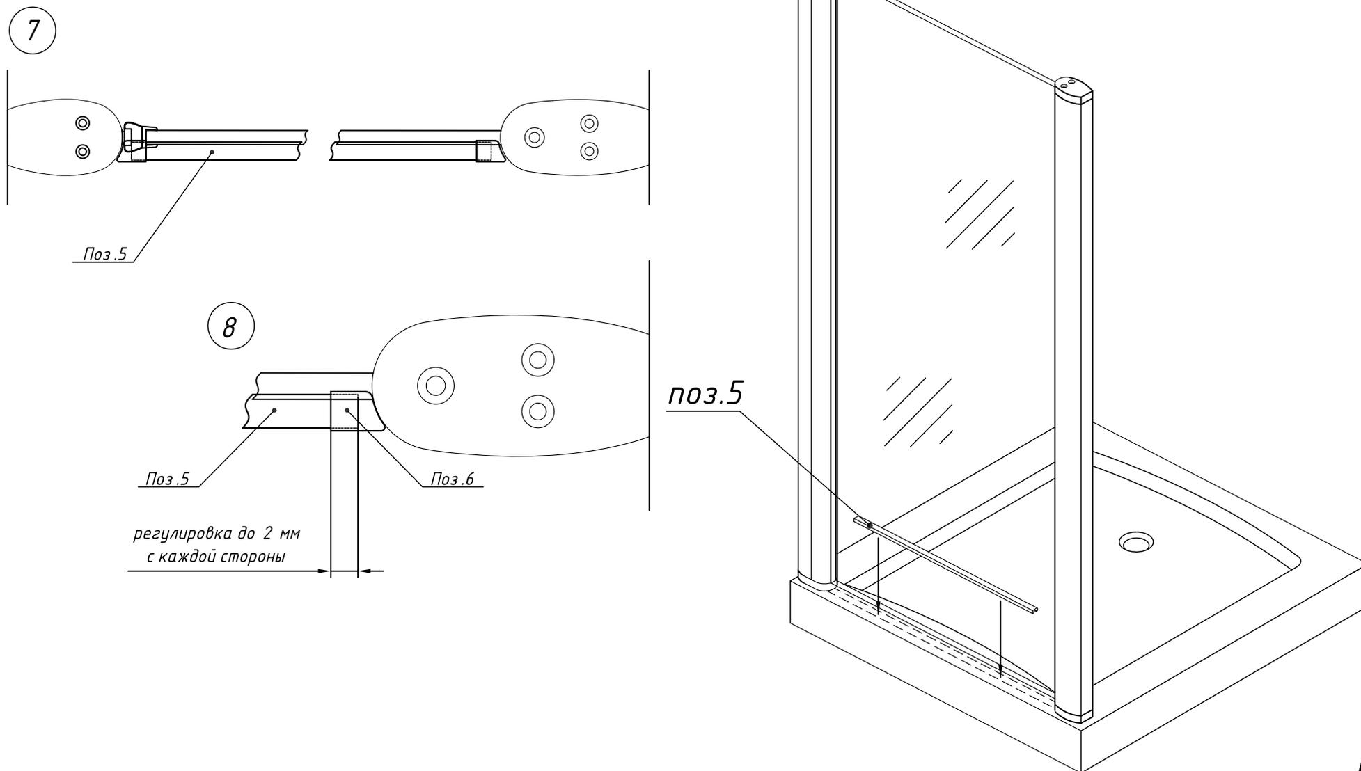
9. Установить силиконовый уплотнитель на низ дверного полотна.
