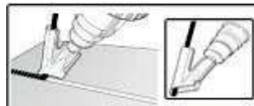
перехода материала в тестообразное состояние. Подвести сварочную проволоку и заполнить образующимся из нее расплавленным материалом зазор таким образом, чтобы образовался равномерный наплыv. Учтите, что диапазон температуры между тестообразным и жидким состоянием синтетического материала небольшой.
