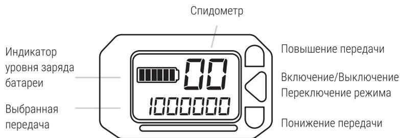
Режимы работы: пробег в течение последнего сеанса использования, одометр, время в пути, напряжение на АКБ
