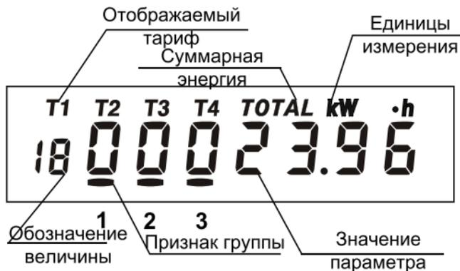
Рисунок 4.1 – Расположение информации на индикаторе
