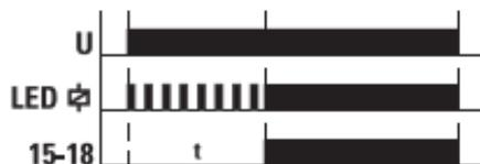
Задержка включения. После подачи питания начинается отсчет времени (T) в это время контакты реле находятся в положении 15 – 16 замкнут, а 15 – 18 разомкнут (реле выключено). По окончании отсчета времени контакты 15 – 16 размыкаются, а контакты 15 – 18 замыкаются (реле включено) и продолжают находиться в таком положении до отключения питания.
