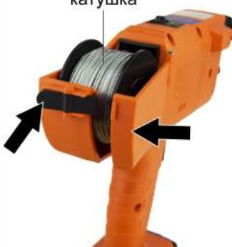
Произведите пробную вязку. Если проволока не выходит из направляющей насадки, попробуйте переустановить катушку.
