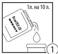
Шаг 1 - Приготовление промывочного раствора
