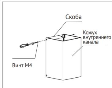
4. Прикрепите фиксирующую скобу к внутреннему телескопическому коробу винтами M4.
