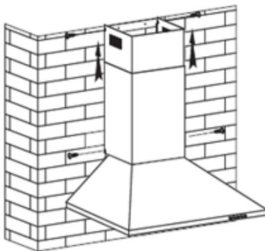
8. Выдвиньте внутреннюю часть короба на высоту саморезов, подвесьте короб на саморезы за фиксирующую скобу. По отверстиям скобы отметить и просверлить 2 отверстия диаметром 8 мм и глубиной 75~85 мм. Далее следует выровнять фиксирующую скобу с отверстиями и затянуть саморезами 5x60.
