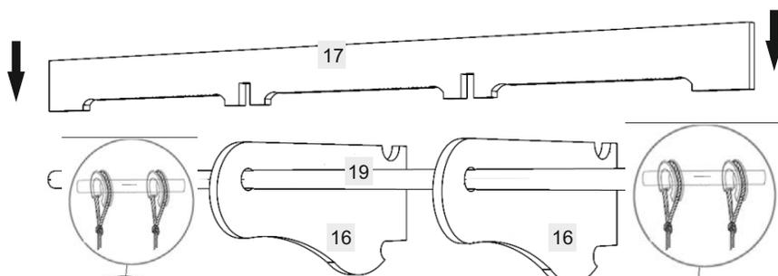
Крепления катушки защищают тросы навесного оборудования от перетирания, а фиксаторы надежно удерживают и позволяют регулировать длину тросов.
