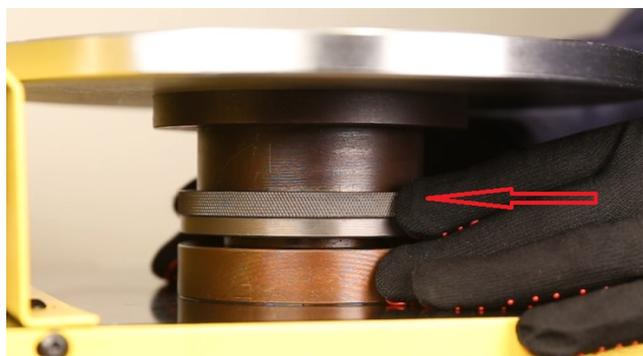
3. Рабочим инструментом является фрезерная головка с двумя сменными пластинами. Чтобы получить доступ к головке необходимо ослабить стопорящий диск и открутить круглый стол полностью.
