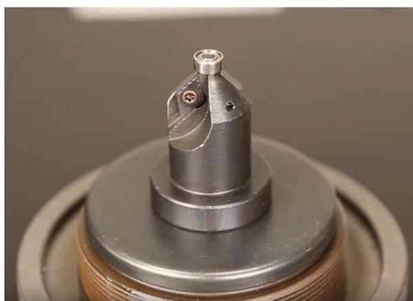
4. Для поворота или замены режущих пластин с изношенными кромками выкрутите винты крепления.
