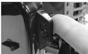
Рис.9 Закрытие воздушной заслонки
