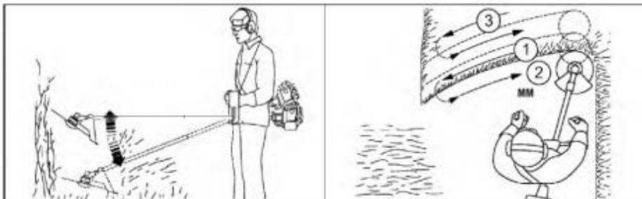
При кошении высокой травы действуйте в три этапа: 1. Обрезка верхней части стеблей. 2. Кошение по центру стебля. 3. Кошение в нижней части стебля. В противном случае, длинные стебли будут наматываться на штангу и кожух триммера.
