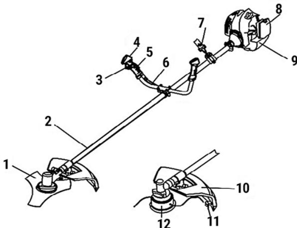
Рис.1.1 Расположение основных узлов и органов управления Yanis BC43-63
