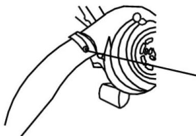
Закрепите выпускную трубу используя винт М5
