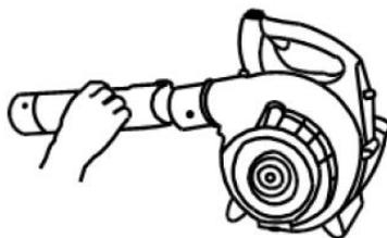
Вращающим движением вставьте собранную выпускную трубу в инструмент
