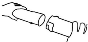
Вращающим движением вставьте выпускную трубу (В) в выпускную трубу (А), закрепите винтом
