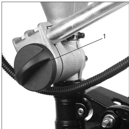
**Рис. 11** Регулировка положения румпеля
