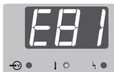
Пример аварийного сигнала о перегреве
