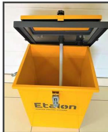
Отстегнуть - снять крышку бака. Засыпать краску не более 80 % от объема бака.
