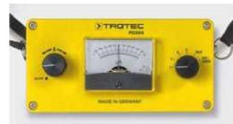
Кроме того, генератор импульсов способствует быстрому обнаружению утечки с помощью зеленой сигнальной лампы и, при необходимости, дополнительно подключаемого акустического передатчика сигнала. И то, и другое осуществляет прием через крышу почти со всех сторон.
