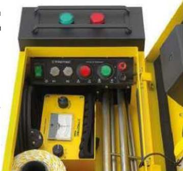
**Легкий, прочный, универсальный PD200 позволяет надежно обнаруживать утечки на плоских крышах, террасах, бассейнах, прудах или изоляционных покрытиях полигонов...**
