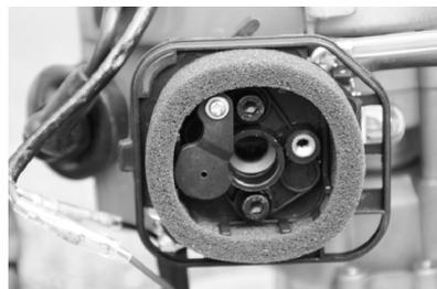
Если вам приходится использовать пылесос-воздуходувку в особо пыльных условиях, производите очистку воздушного фильтра после каждых 8 часов работы устройства.
