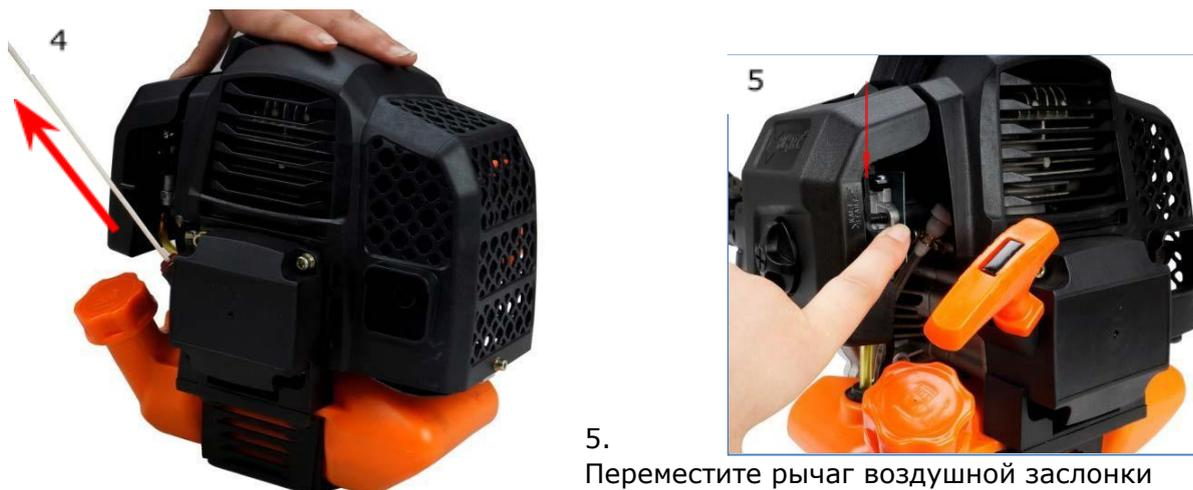
5. Переместите рычаг воздушной заслонки карбюратора в положение «WARM START».
